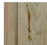
Holz verändert sich durch Lagerung und Verarbeitung im Volumen und in der Dichte. Ein Phänomen bei Nadelhölzern während dieses Vorgangs ist das Austreten von Harz an die Oberfläche. Dies ist vollkommen normal und kann im Nutzbereich durch ein Abschaben und vorsichtiges Entfernen mit Hilfe von Terpentin behoben werden.
