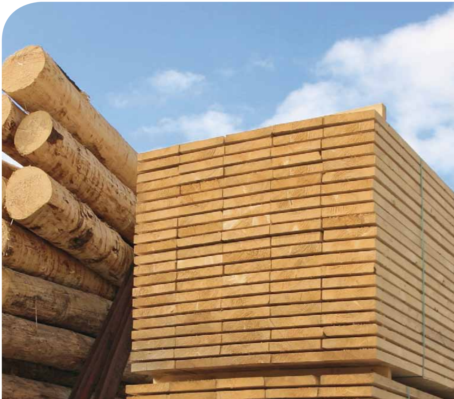
Dielen sägerau, im Prinzip scharfkantig, technisch getrocknet
